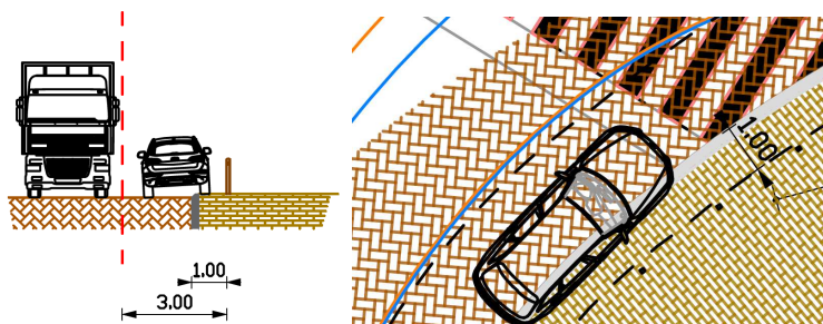
Figuur 2.5: Schuine band om uitwijken in geval van nood mogelijk te maken.
