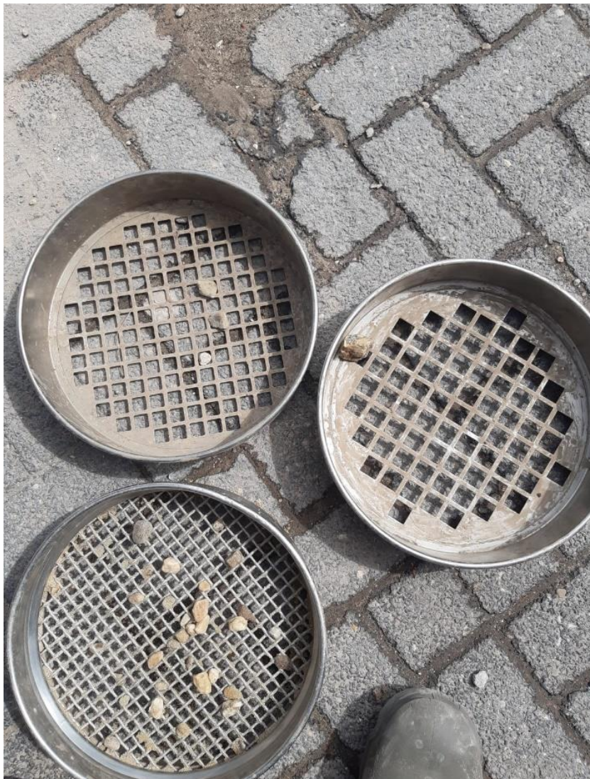
P2022-1129, Bodemlaag Dp1 1,0 - 3,7 m-mv kelder politiebureau Hilversum, foto zeefproef
