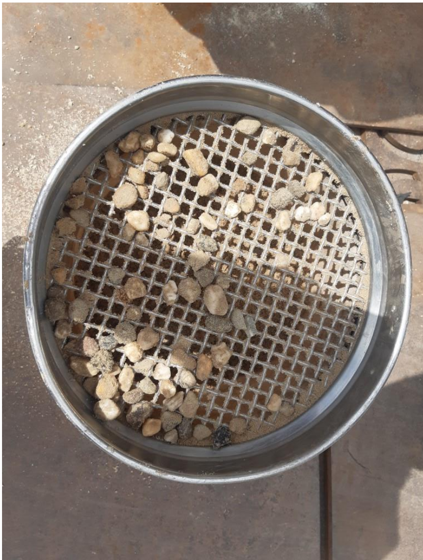
P2022-1130, Bodemlaag Dp2 1,0 - 3,7 m-mv kelder politiebureau Hilversum, foto zeefproef
