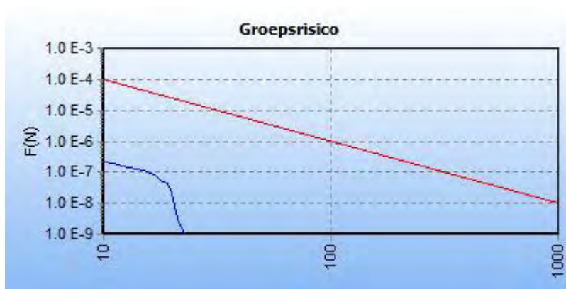
Figuur 5.1 FN curve voor 6865_leiding-W-533-03-deel-1 van N.V. Nederlandse Gasunie voor de kilometer tussen stationing 3150.00 en stationing 4150.00
