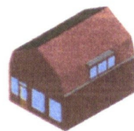
Dakkapel in mansardekap in onderste dakvlak plaatsen en aansluiten op knik
