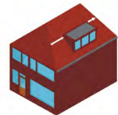
Bij schilddaken de kleinste afstand hanteren voor de plaatsing in het dakvlak
