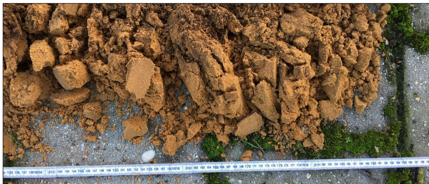
Figuur 6: Tot 190 cm geen grondwater;
