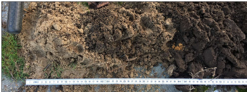
Figuur 4: 0-25 cm: cunetzand. Vanaf 25 cm-mv: bruin, humusrijk zand;
