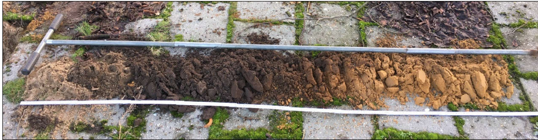
Figuur 3: Profiel grondboring op locatie bewortelingsonderzoek 1;
