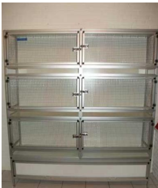
Figuur 23 Toren van Otten Petcages. 2 lagen kunnen geschikt gemaakt worden voor de opvang van konijnen en 1 laag voor verblijven voor knaagdieren. In de konijnenkooien past precies een onderbak in.
