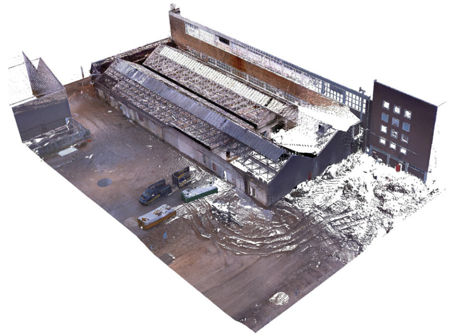
3d inmeting Digitale 3D inmeting naar een pointcloud.
